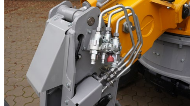
Serienmäßig 65 l/min Fördermenge im ersten Zusatzkreis für verschiedene Anbaugeräte inkl. serienmäßige Druckentlastung.
